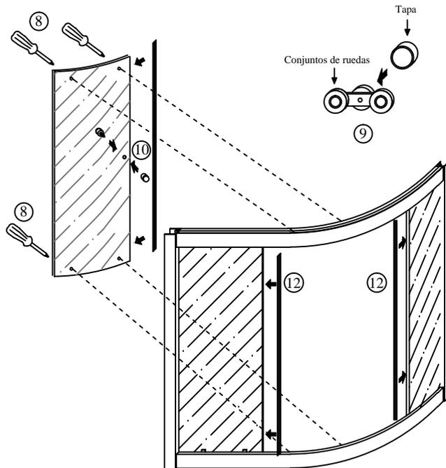
(8) Coger el cristal movil izquierdo y desde el interior de la bañera montarlo en la manpara atornillandolo a los conjuntos de ruedas, primero a los dos del perfil superior y despues a los del perfil inferior.
